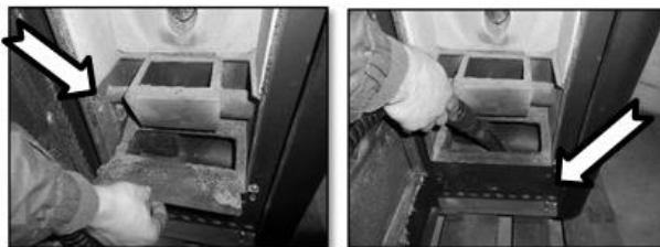
Figura 34 - Limpeza do alçapão
