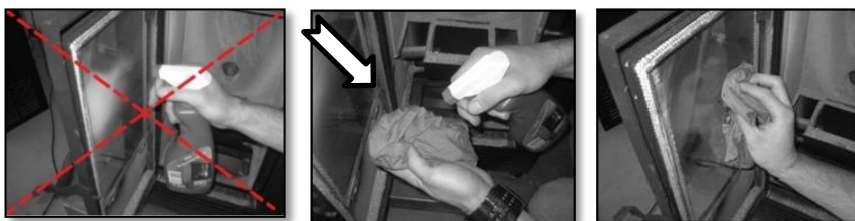
Figura 35 - Limpeza do vidro: a) limpeza incorreta do vidro; b) aplicar líquido no pano; c) limpar o vidro com o pano
