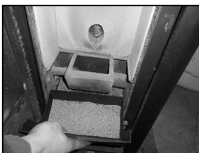
Figura 33 - Limpeza da gaveta de cinzas
