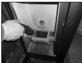
Figura 32 - Limpeza do interior
